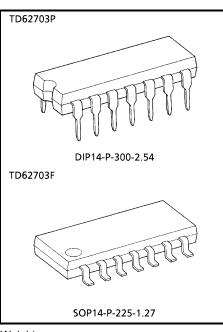
Weight DIP14-P-300-2.54: 1.11 g (typ.) SOP14-P-225-1.27: 0.16 g (typ.)
